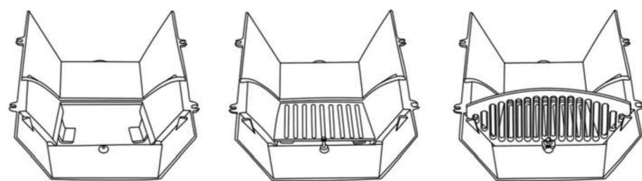
Положите топливник на ровную поверхность. Поместите огнеупорный камень на место и затем вставьте болт в отверстие прямо под ним. Вставьте колосник в пазы топливника над гайкой M6. Закрепите с помощью шайбы M6 и болта M6.
