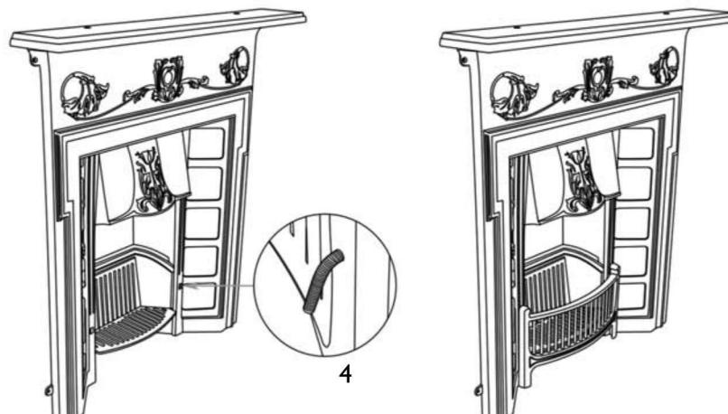
Зафиксируйте 2 крепежные шпильки с обратной стороны декоративной решетки (рис.4).
