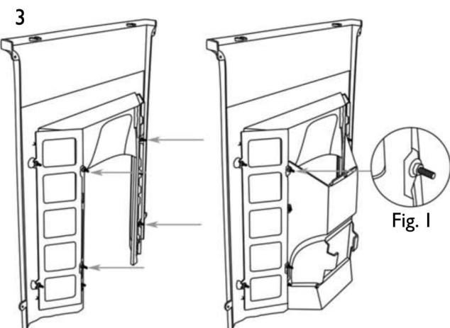
Вставьте 4 гайки M6 с обратной стороны портала. Прикрепите топливник сзади портала, убедившись что гайки M6 проходят через крепежные скобы с обратной стороны топливника. Закрепите и затяните используя 4 шайбы и 4 гайки M6.
